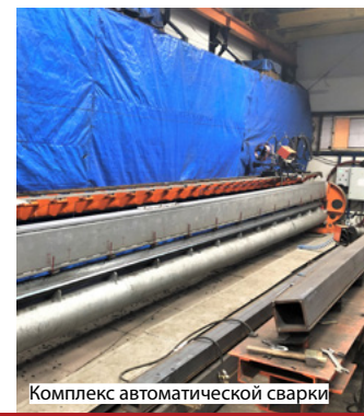
Проводники коробчатые. Длина изделий в заказе от 6 до 12 метров. Вес 12-метрового проводника 1,3 т. На сегодняшний день половина партии уже изготовлена
