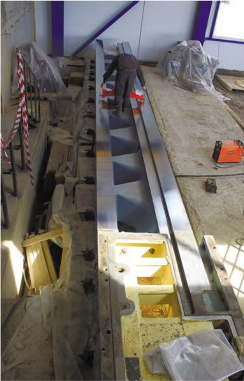
Нивелировка станины тяжелого станка 1А660.400 Ф1
