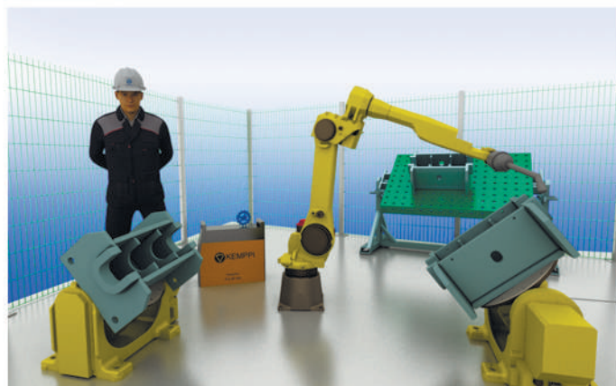
Внешний вид участка роботизированной сварки
