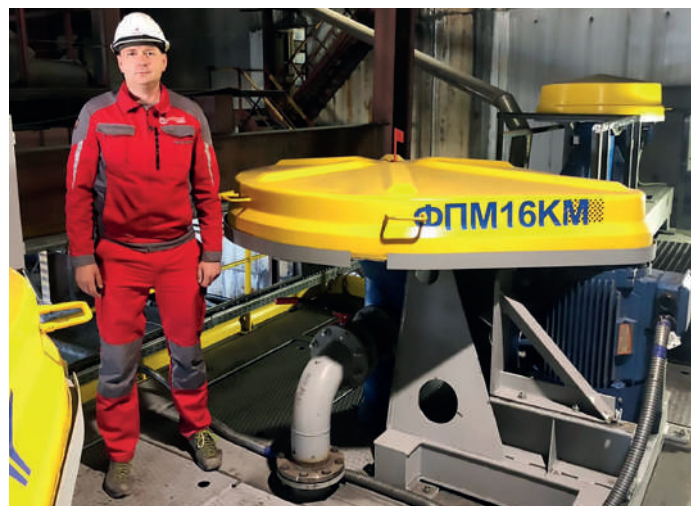
Главный обогатитель «Канекс Технологии» Алексей Никитин на монтаже. Флотомашинный узел ФПМ16 модернизирован специально для работы с частицами высокой плотности: укомплектована аэроузелом повышенной износостойкости и гуммирована в местах абразивной нагрузки
