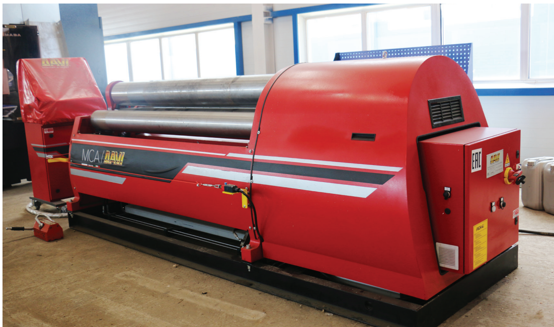
Новая гидравлическая четырехвалковая листогибочная машина с ЧПУ Dava MCA
