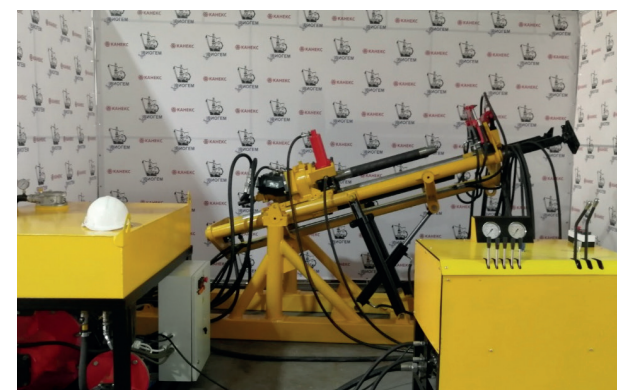
Установка лучевого бурения УЛБ-130
