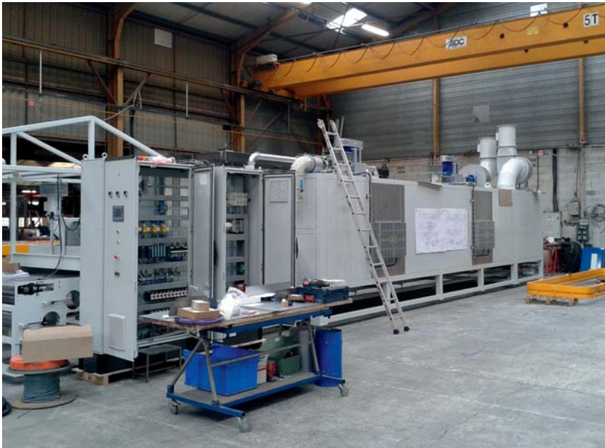
Рис. 2 Сборка 12-метровой промышленной СВЧ-сушки (Франция)
