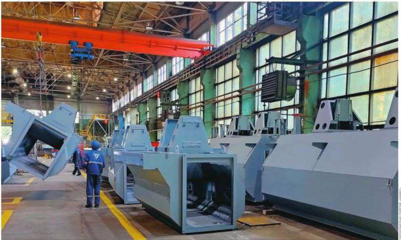
Группа «Канекс» укомплектовала строящуюся обогатительную фабрику «Дальграфит» флотомашинами собственного производства. Всего на объект поставлено 12 флотомашин объемом от 1,2 до 6,3 кубометра
