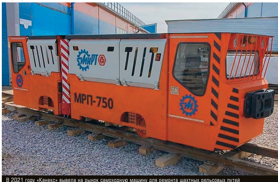
В 2021 году «Канекс» вывела на рынок самоходную машину для ремонта шахтных рельсовых путей
